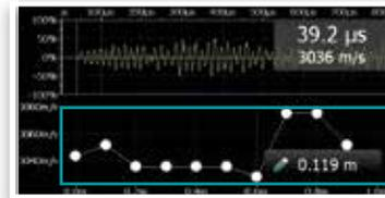
Evalúa la uniformidad del hormigón y detecta grietas así como otros defectos. Las velocidades de pulso son visualizadas en forma de línea.
