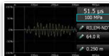
Determina la resistencia a la compresión usando la correlación de velocidad de pulso ultrasónico o usando SONREB.
